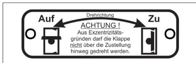
**Bild 2-2:** Hinweisschild der Drehrichtung
