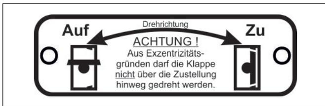
Bild 3-5: Hinweisschild der Drehrichtung
