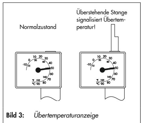
Schließt das Ventil aufgrund von Schmutzpartikeln zwischen Sitz und Kegel oder bei defektem Balg nicht, wird die eingestellte Temperatur überschritten. Daraufhin spricht die Übertemperatursicherung an (vgl. Bild 3). Die überstehende Stange signalisiert den Defekt.
