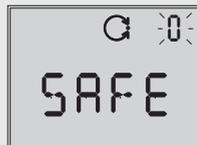
La válvula va a su posición de seguridad.
