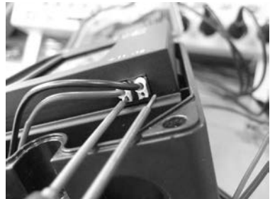
Bild 13 · Federzugklemme mit Prüfabgriff
