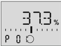
Angezeigt wird Code **P0**, Stellungsregler befindet sich im Regelbetrieb, erkennbar am Regelsymbol
