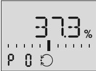
Standardmäßig befindet sich der Stellungsregler nach einmal erfolgter Initialisierung im Regelbetrieb. Erkennbar am Regelsymbol
