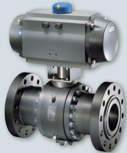
**SAMSON VETEC** – Das Maxifluss-Stellventil von VETEC vereinigt die Stärken von Stellventilen, Stellklappen und Kugelhähnen. Die universelle Konstruktion ermöglicht den Einsatz bei Standardapplikationen bis hin zu kritischen Anwendungen. Dank seiner exzentrischen Lagerung berührt der Drehkegel den Ventilsitz nur beim vollständigen Schließen. Das Ventil kann daher mit großem Stellverhältnis regeln.
