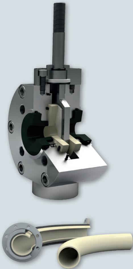
**SAMSON LEUSCH** – Armaturen für Rohrdurchmesser bis drei Meter gehören zur Kernkompetenz des Spezialherstellers. Seine Regel- und Absperrklappen, Kugelhähne und Kugelsektorventile, die weich oder metallisch dichtend schließen, sind sowohl für extrem hohe und niedrige Temperaturen als auch große Drücke geeignet: von  $-196$  bis  $+1000$  °C, für Druckstufen bis PN 420/Class 2500.
