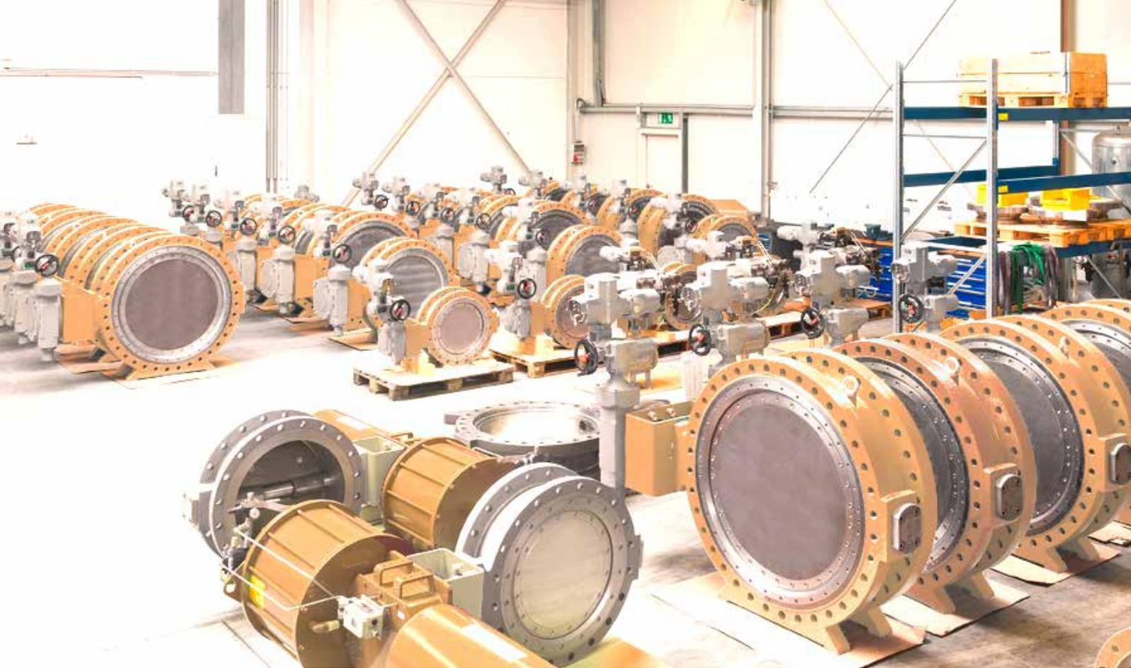
Der dreifach exzentrischer Sitz der Regel- und Absperrklappe LTR 43 in konischer Form weist viele Vorteile auf: Bei der geringsten Schwenkbewegung hebt sich der Dicht-ring vom Gehäusesitz ab (kein Übergang von statischer zu dynamischer Reibung zwischen Sitz und Kegel).
